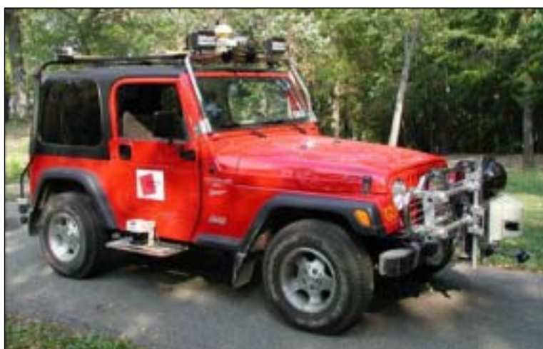
図-10. 「Navlab」自走式インテリジェント走行（車間距離・速度）制御システム
